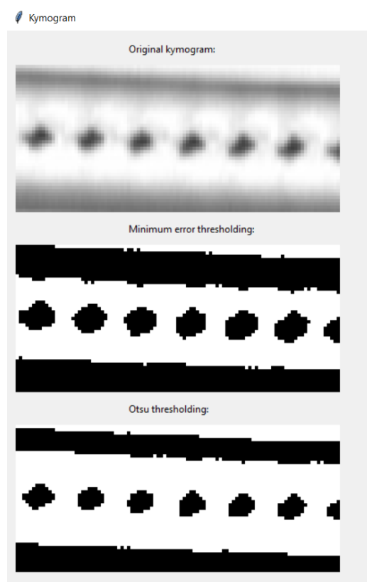
Obrázek 7.2: Ukázka okna, které zobrazí metoda 1. Vrchní obrázek je původní videokymogram, spodní dva jsou videokymogramy po aplikaci segmentací Kittler a Otsu.
