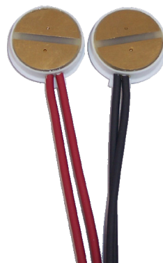
Obrázek 3.2: Elektrody elektrolottografu EG2-PCX2 od společnosti Glottal Enterprises
