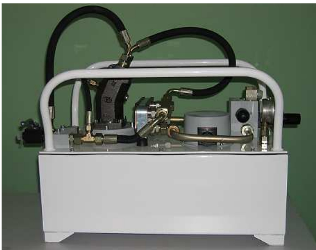
Obrázek A.8: Vývojový funkční prototyp transformátoru RIT.
