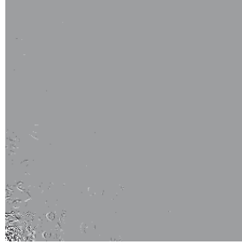
Haarova báze, 1/64 největších koeficientů kvantizována s velkou přesností, zbytek s „přesností“ 0 bitů (tj. koeficient byl vyhozen, indikace šedou barvou)
