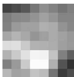
blok po kvantizaci DCT koeficientů a následné dekompresi
