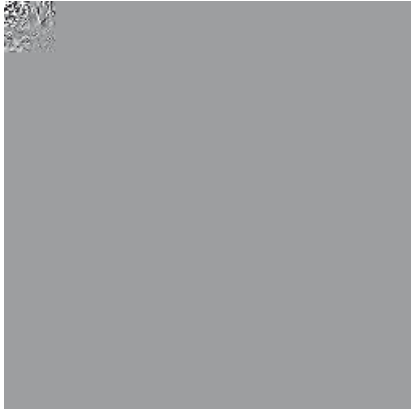
Haarova báze, 1/64 koeficientů kvantizována s velkou přesností, zbytek s „přesností“ 0 bitů (tj. koeficient byl vyhozen, indikace šedou barvou)
