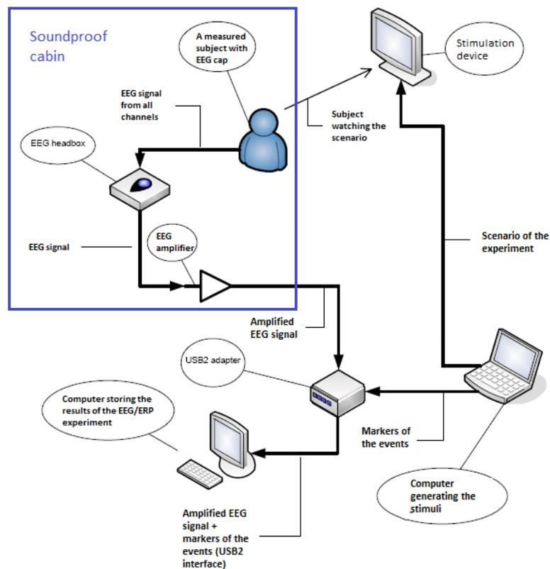
Figure 7: EEG laboratory - Diagram [28].
